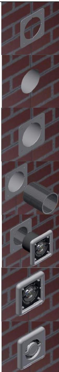
3. Utilice la plantilla para marcar el lugar donde se hará la perforación para el pasaje del tubo.
